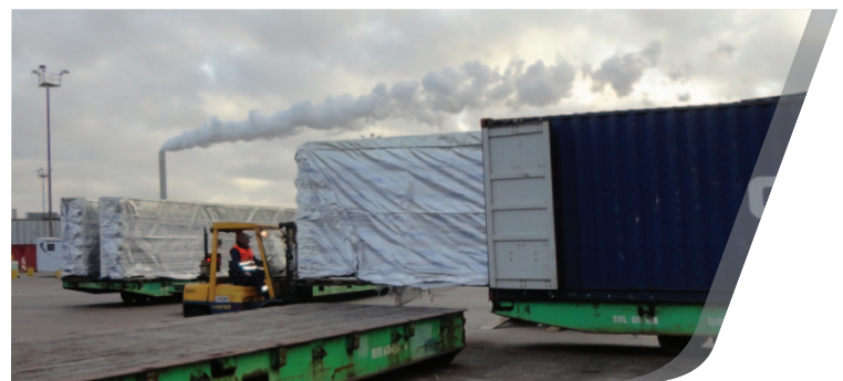
Abbildung 5: Ein Motorsatz Tischkühler pro 40-Fuß-Container (Foto: Rolls-Royce Power Systems AG)
