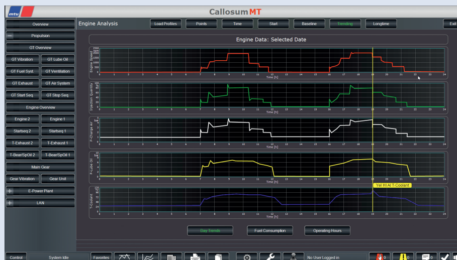
Abbildung 6: Die Trendanalyse wichtiger Motor-Parameter hilft Schäden vorzubeugen.
