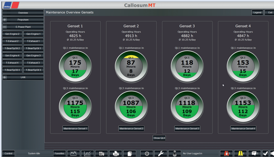
Abbildung 1: Übersichtliche Darstellung der Betriebsstunden und nächsten anstehenden Wartungen für das gesamte Antriebs- und Bordstromsystem in Callosum MT.
