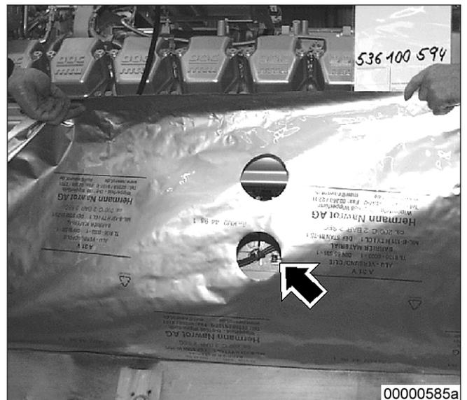
3. Den Feuchtigkeitsanzeiger und das Sichtfenster in die Aluminiumverbundfolie einschrauben.
